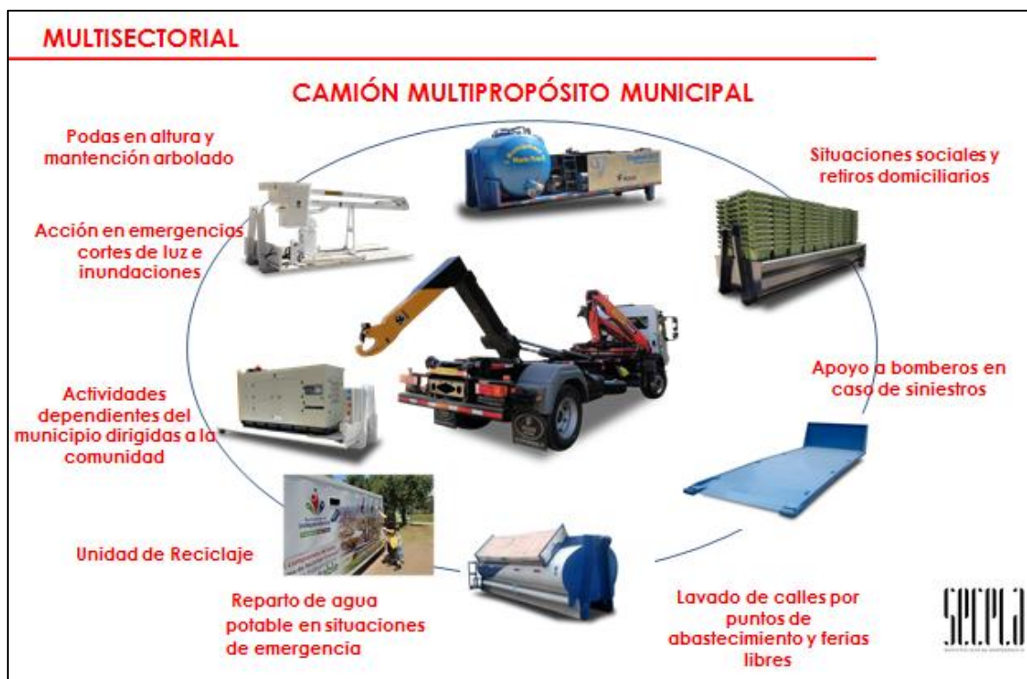
Figura 3: Funciones del camión Multipropósito
